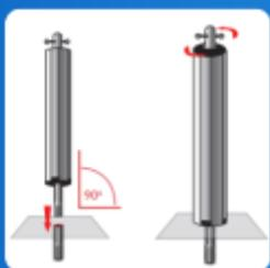
ベースソケットのフタを取り、延長用ポールをソケットに取り付ける。延長用ポールが地面に対し正しい角度であることを確認すること。ベースソケットに挿入し、しっかりとねじ込むこと。
