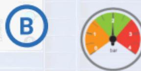
**B** 空気圧計が約2 bar（緑色の範囲）になるまでポンプ用ハンドルを上下に動かして膨張シールを膨らまし続ける。
